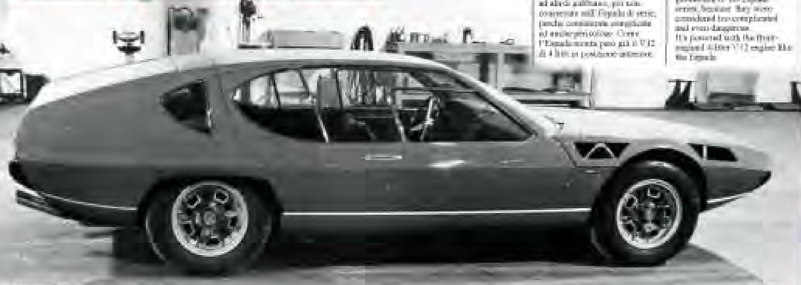
Il prototipo della March di Bertone, con il motore V12 in posizione anteriore
